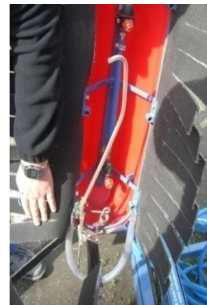
Ansamblul pentru deconectarea jetului pulverizat
