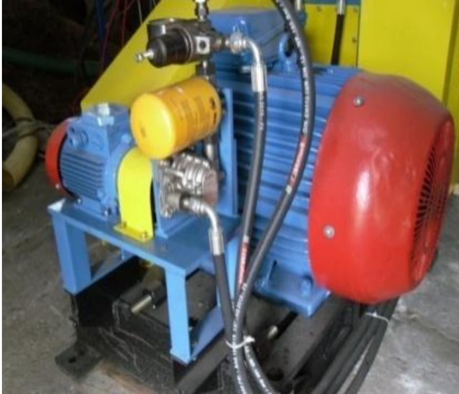
Stația de lubrificare
